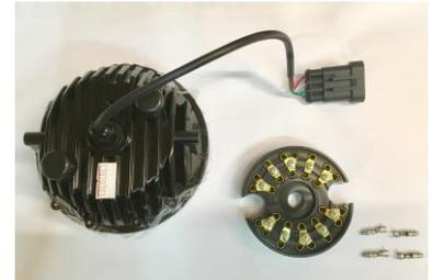
4. den Kabelstrang kürzen und die Leitungen entsprechend dem nebenstehenden Bild abisolieren
